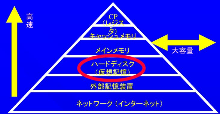
主記憶装置では比較的安価で大容量なDRAMが使われているが、さらに大容量のメモリを安価に実現したい
